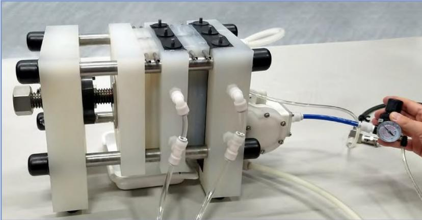
MicroPress™ es una nueva prensa de filtro innovadora a escala de banco que es fácil de operar y perfecta para sus necesidades de prueba piloto industrial. Consulte MicroPress™ para sus aplicaciones con bajo contenido de sólidos.
